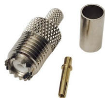
Mini UHF hun (F) Product no: 15780 Type: Crimp Cable: RG58 Ohm: 50
